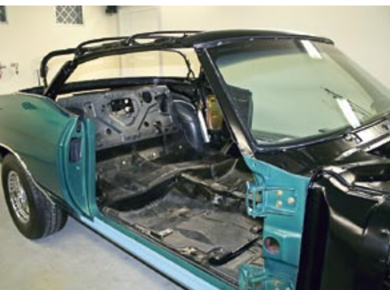
Även cabställningen har varit demonterad i molekyler och renoverats. Den har lackerats med samma noggrannhet som övriga delar, dvs. proceduren med blästring, epoxygrund, filler, slipning, svart bas och halvblank klarlack.
