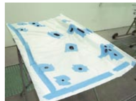
Tobba Olsson vill gärna få den gröna pearlen snyggt applicerad inuti hålen på undersidan av huv och baklucka. Därför maskeras ytorna och "hål" lackas vid annat tillfälle än resten av insidorna. Petigt kanske men snyggt!
