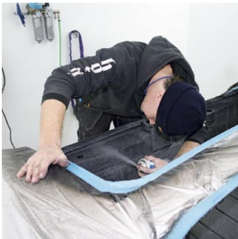
När den svarta bottenfärgen härdat sprutas så kallad splatter paint – en nyans som användes original av GM.
