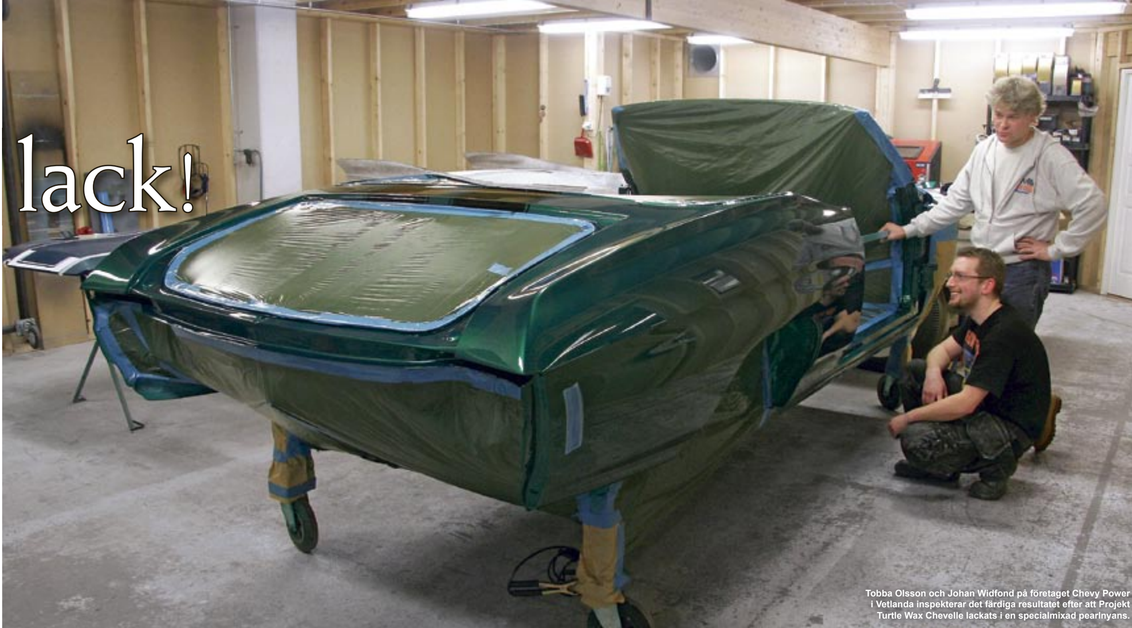
Det iordninggjorda bagageutrymmet maskeras och karossen är nu redo att sprutas med en vit bas. En vit grundfärg användes som sista lager och som mattades ner med 400-papper.
