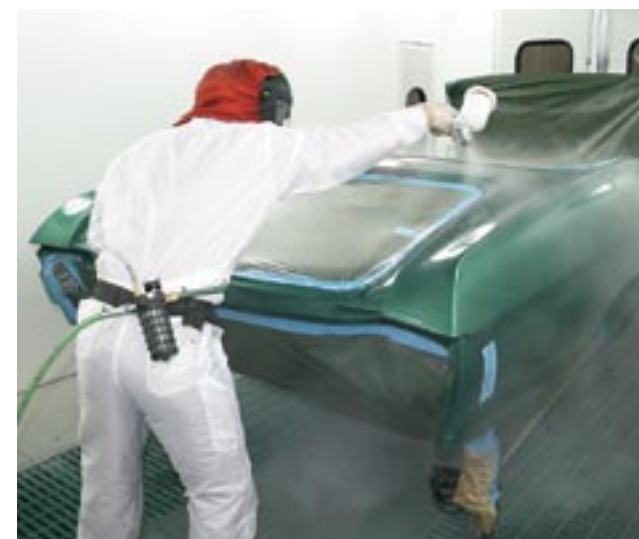
Tobba Olsson vill gärna få den gröna pearlen snyggt applicerad inuti hålen på undersidan av huv och baklucka. Därför maskeras ytorna och "hål" lackas vid annat tillfälle än resten av insidorna. Petigt kanske men snyggt!
