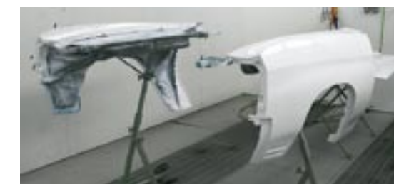
Alla lösa delar sprutas separat. Den vita basfärgen är en helt obruten nyans som även klarlackas. Basen mellanslipas innan den gröna pärlemorlacken läggs. Det vita kan även läggas utan klarlack och få det gröna vått i vått. Tobba föredrar att låta det vita torka och mellanslipa istället.
