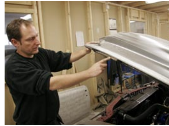
Sven Billred visar hur man bearbetat huvan några millimeter för att passningen mot skärmen ska bli perfekt.
