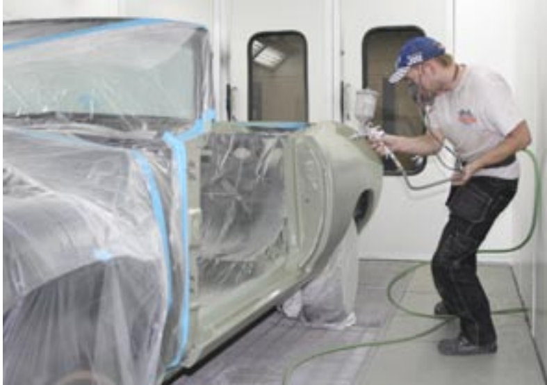
Epoxyen är grön till färgen och alla lösa delar sprutas i lackboxen.
