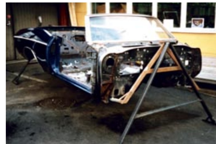
Första steget var att demontera Chevelen i molekyler. Efter ramlyftet placeras karossen i en snurrställning för att kunna sandblästras.
