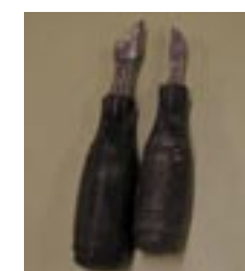
Sven Billred har tillverkat två verktyg som han använder för att ritsa korrekt springa mellan plåt-detaljerna.
