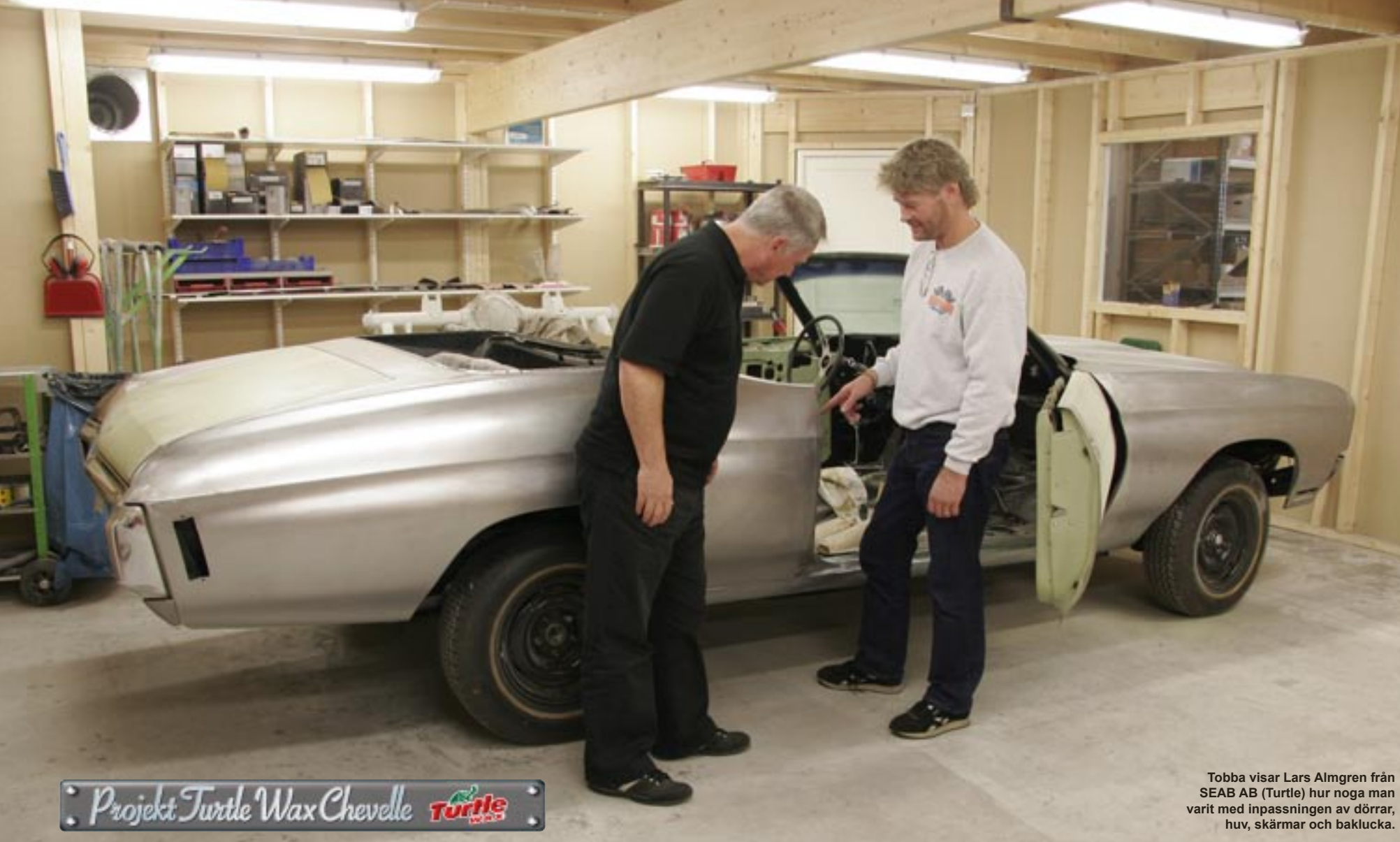
Sven Billred visar hur man bearbetat huvan några millimeter för att passningen mot skärmen ska bli perfekt.
